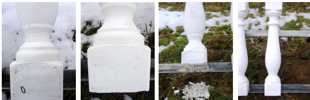
Abb. 1 bis Abb. 4: Einfluss der Massehydrophobierung auf die Dauerhaftigkeit nach 2 Monaten (Abb. 1 und Abb. 2) sowie nach ca. 12 Monaten (Abb. 3 und Abb. 4). Unbehandelt zeigen sich deutliche Schädigungen im Bereich der Einschnürungen und der Säulenfüße (Abb. 1 und Abb. 3).
