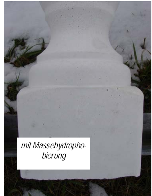
gleichmäßig heller Farbeindruck, keine Schwindrisse im Bereich der Einschnürung, Alter ca. 2 Monate
