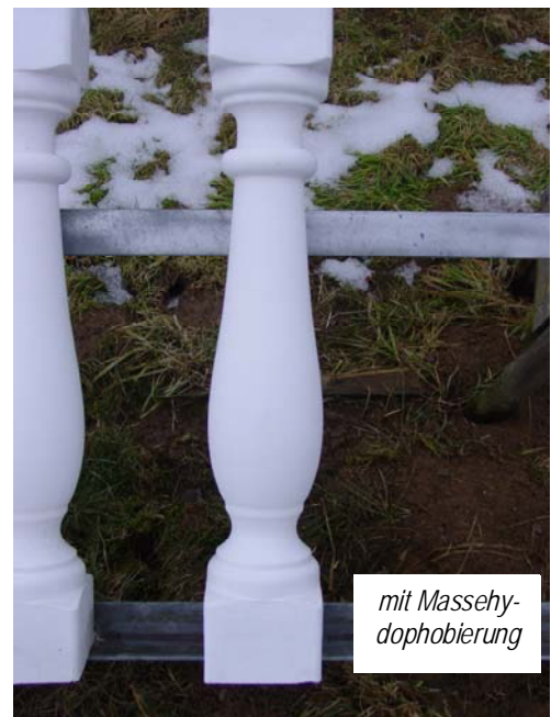
gleichmäßig, heller Farbeindruck, keine Schwindrisse im Bereich der Einschnürung, keine Abplatzungen zu beobachten, Alter ca. 12 Monate
